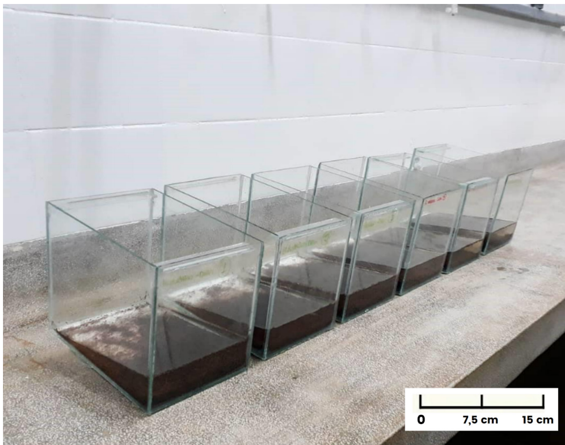
Figura 4 – Aquários parcialmente inclinados, com pequena coluna de água de altura variável ao longo de sua extensão e turfa com até dois centímetros de altura na região mais profunda, mantidos no Laboratório de Ictiologia do ICMBio/CEPTA. Fonte: Davi H. Oliveira (2021).
