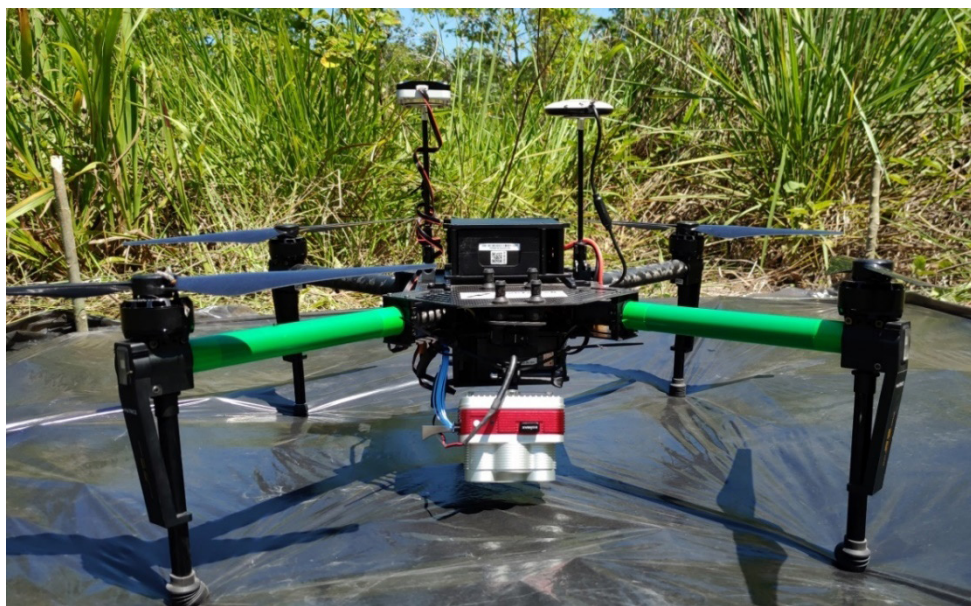
Figura 2 – RPAS Matrice 100 com integração da câmera Micasense Altum e DLS 2 (haste esquerda).
