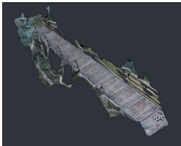
Figura 6 - Texturização da Trilha Lagoa da Mata, FLONA Carajás, Pará; nesse resultado mostra a reconstrução do objeto da ponte e falhas em partes da estrutura próximas da vegetação.
