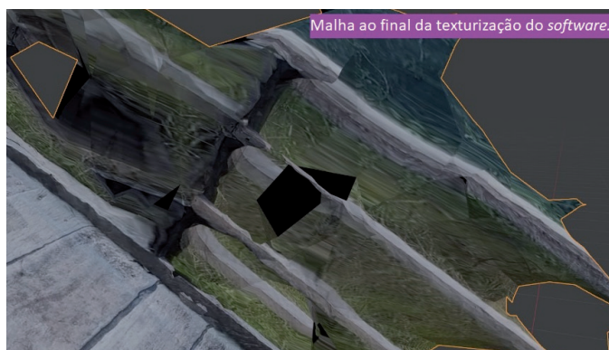
Figura 5 – O mosaico de imagens representando o processo de modelamento 3D da ponte reconstruída; na primeira etapa o software gera linhas de polígonos, após a texturização há o preenchimento com a imagem 2D. Aqui podemos ver claramente a deformação nas sobreposições foto x textura.
